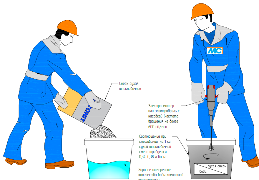
Рис. 29. Организация работ по затворению сухой шпаклевочной смеси
